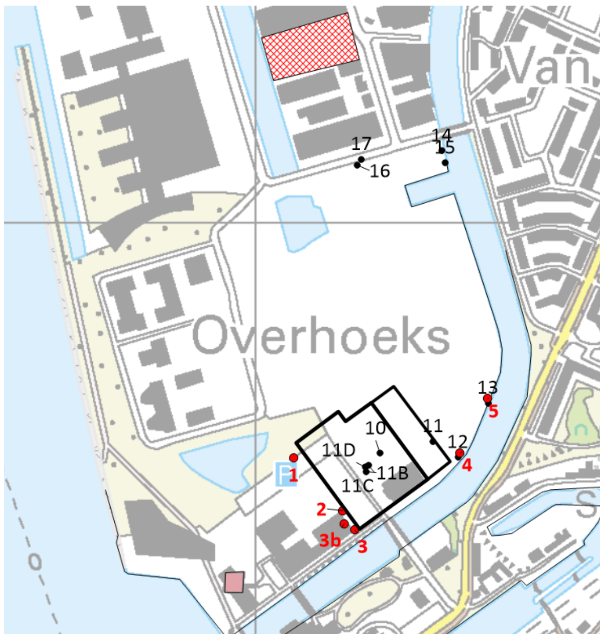
Figuur 5-1 Peilbuizen Tjaden in watervoerend pakket
