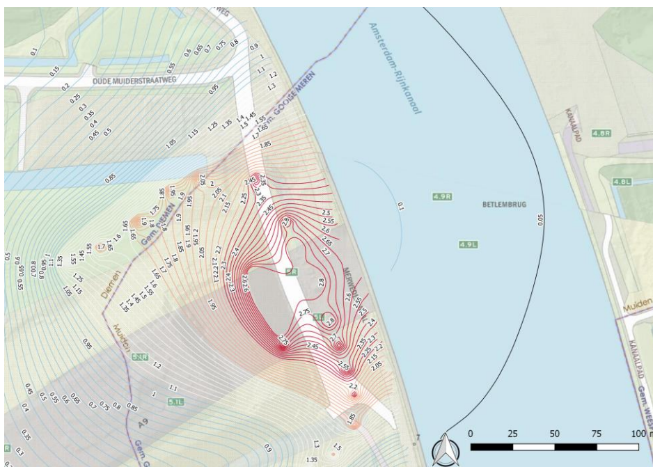
Figuur 12 Grondwaterverlaging (m) gedurende langdurige bemaling van de 1e zandlaag, met focus op de projectlocatie. In totaal zijn 34 filters gemodelleerd en 5 additionele deepwells nabij de teen v/h talud.
