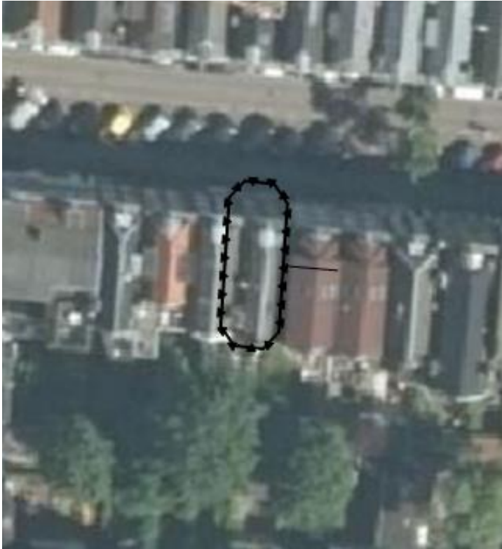
Figuur 4 - invloedssfeer na 95 dagen bemalen in watervoerende laag 1 met waterremmende damwanden
