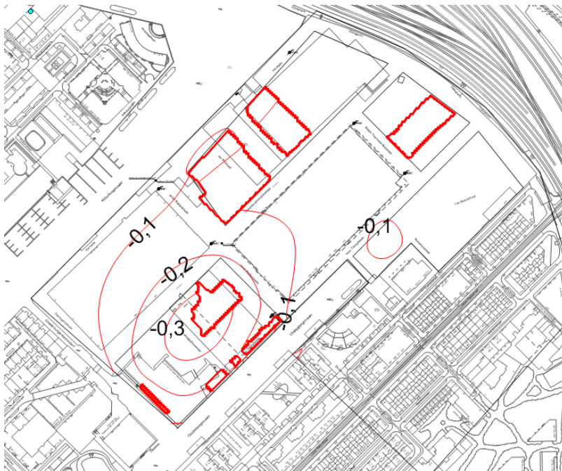
Figuur 11: Scenario 2 berekende grondwaterstandsverandering t.o.v. scenario 1 met waterdoorlatende kades [in meters]
