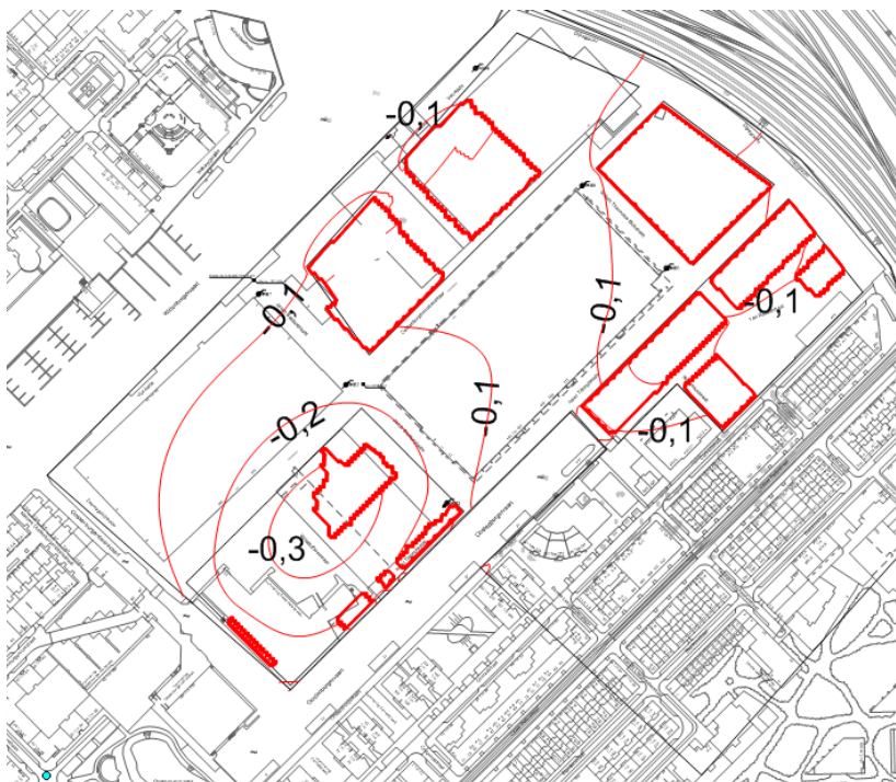
Figuur 12: Scenario 3 berekende grondwaterstandsverandering t.o.v. scenario 1 met waterdoorlatende kades [in meters]
