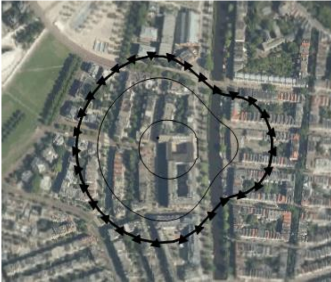
Figuur 4 - grondwaterstand t.o.v. NAP in wadzandlaag na 90 dagen spanningsbemaling (lijn met driehoeken is 0,05m verlagingsslijn)
