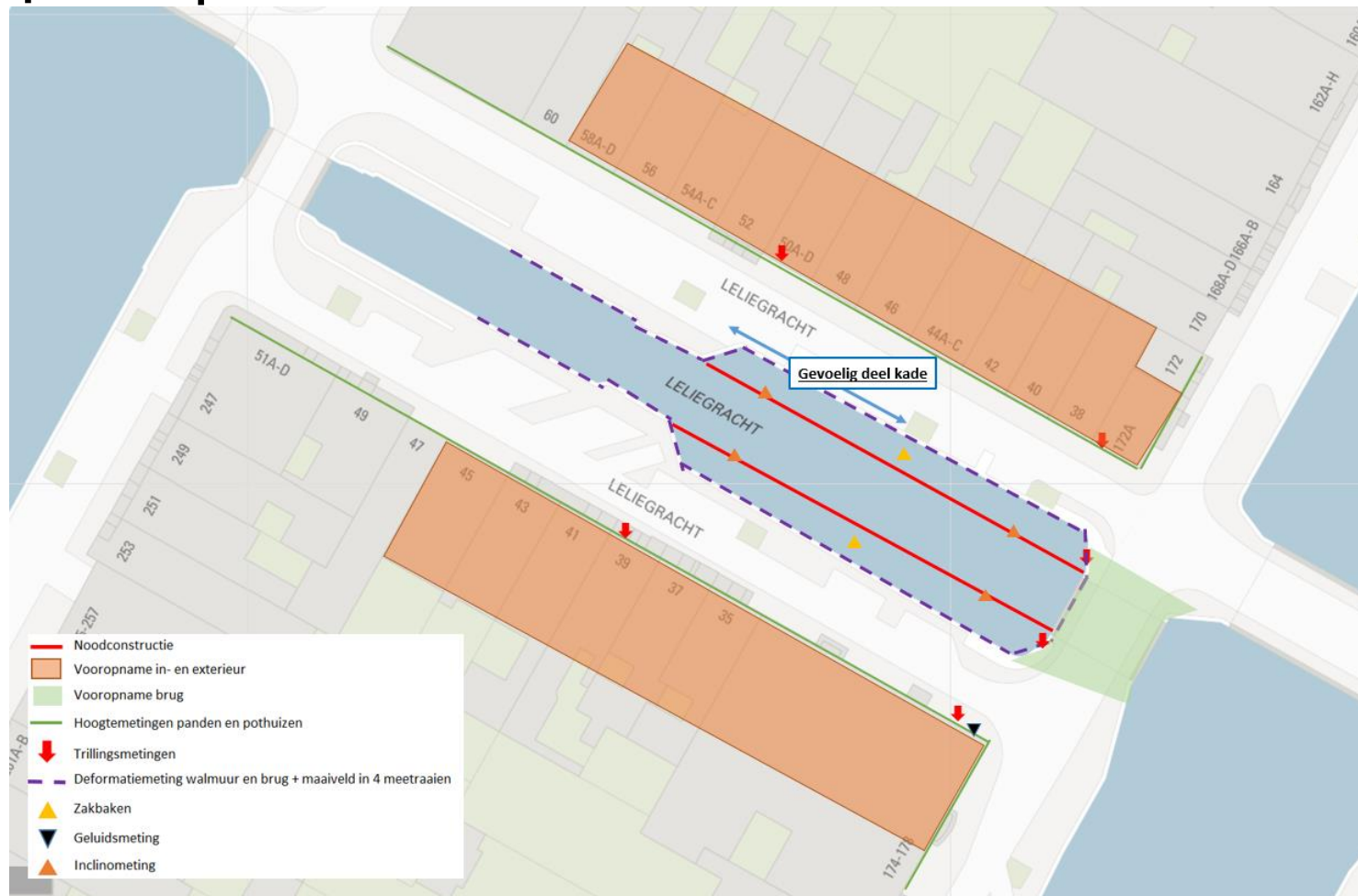
Figuur 1: Schetsmatige meetopzet monitoring omgeving Leliegracht LLG0201 -0202
