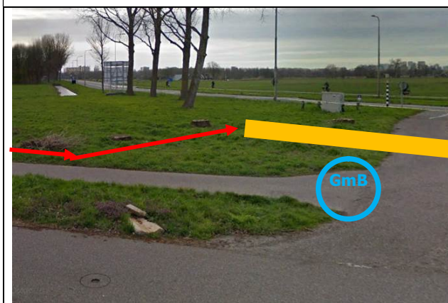
Nieuw te Maken route 40mm buis via nieuw te maken Gestuurde boring richting Nieuw te plaatsen HH OAA_HH001
