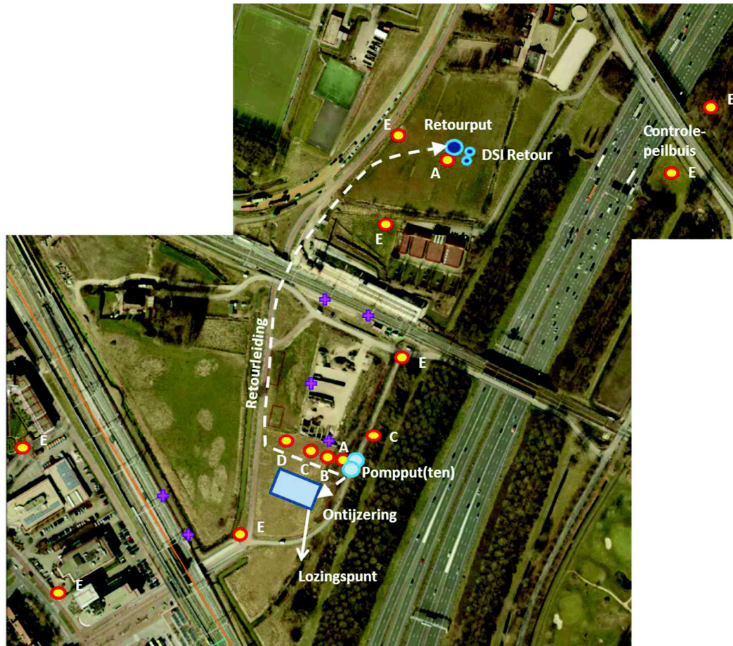
Figuur 1.1 Mogelijke inrichting van de pompproef nabij het gronddepot van Gemeente Utrecht; witte punt = bron en blauwe punt = retourbron; gele punten = puls- of spuitboringen/peilbuizen op 2-10-25-50-100m afstand en 30-100-250-400m afstand; witte pijl = lozingspunt; witte stippellijn = retour in later stadium
