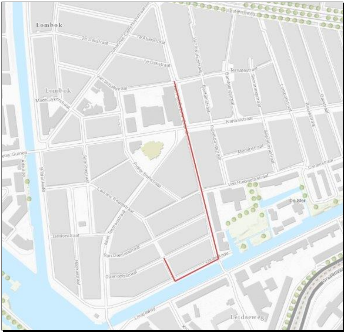
Figuur 1: Aan te leggen hemelwaterriool (rode lijn) in de Jan Pieterszoon Coenstraat, de Leidsekade en de Laurens Reaalstraat (bron: Esri)
