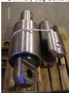
Figuur 9 Voorbeeld Swivel 135 ton
