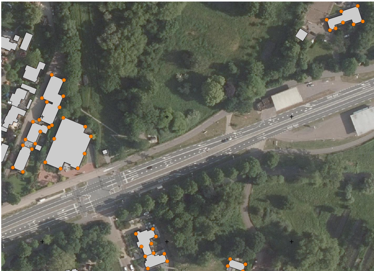
Locaties van te plaatsen deformatiebouten (oranje stippen)
