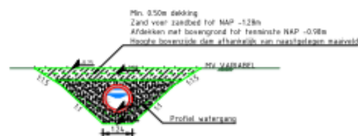
DWARSDOORSNEDE DUIKER HOOFDWATERGANG
