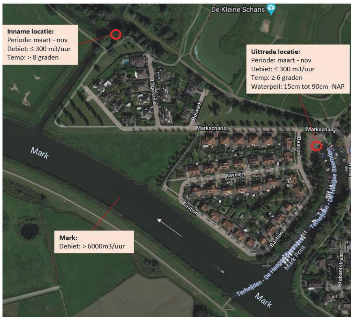
Figuur 1: Door de aanvrager voorgestelde inname en uittrede locatie van oppervlaktewater benut voor thermische energie uit oppervlaktewatersysteem Terheijden.
