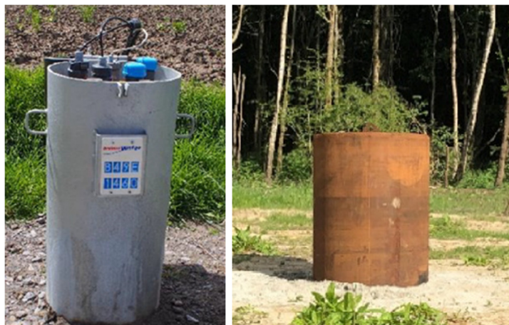
Figuur 1.2 Voorbeeld waarnemingsput (links) en proefput (rechts) afwerkingen
