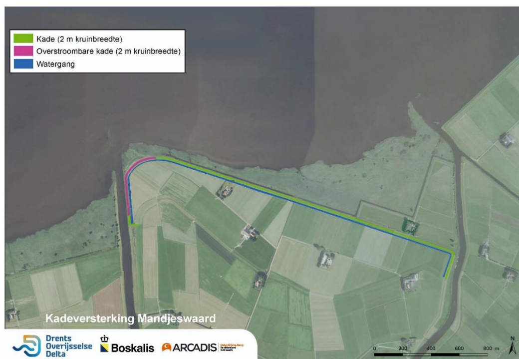
Figuur 4: Overzicht maatregelen in de Mandjeswaard (dijkkring 102). De paarse lijn geeft het overstroombare deel weer. De nieuw te graven watergang loopt langs de binnenteen van de kering (donkerblauw).
