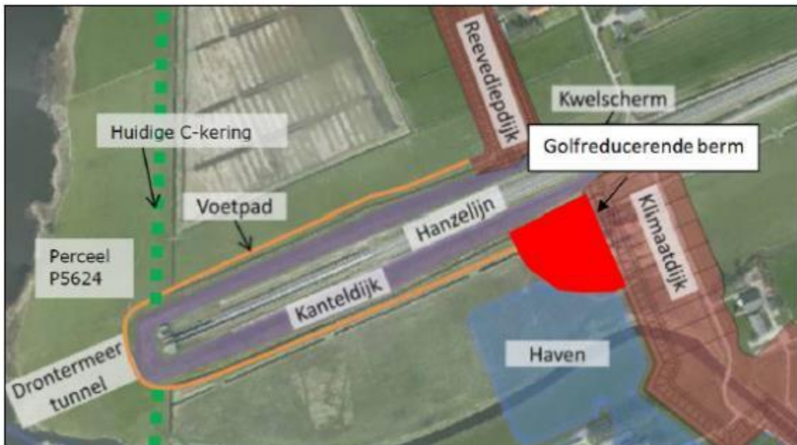
Figuur 4.3: In het rood de aan te leggen golf reducerende berm. Bron: Projectbureau IJsseldelta
