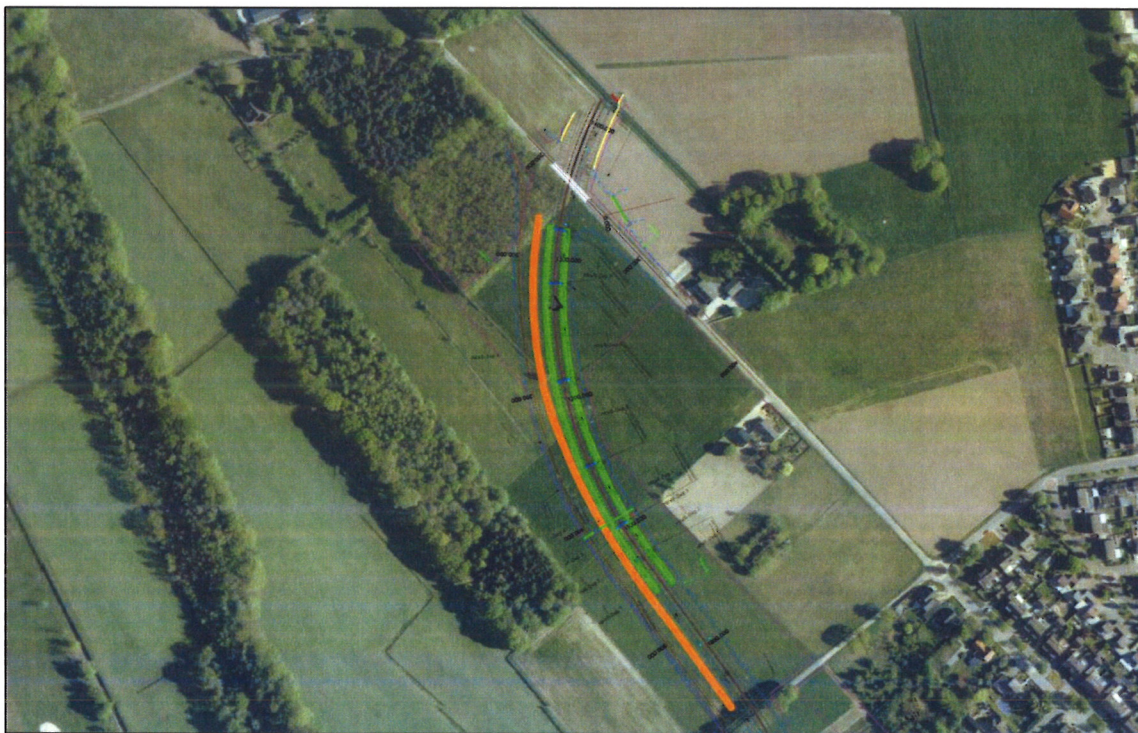
Figuur 2 – Bovenaanzicht projectgebied- oranje is foliescherf en groen zijn de permanente drains.
