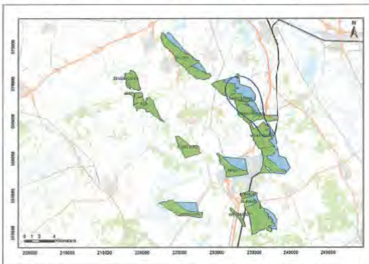
Fig. C1 Nog te verwachten bodemdaling (2013 – 2025) veroorzaakt door de gasproductie uit de voorkomens Appelscha, Assen, Een, Eleveld, Norg-Zuid, Roden, Vries-Noord, Vries-Centraal, Vries-Zuid, Witterdiep en Zevenhuizen (cm). De omvang van het gasvoerend gedeelte van het reservoir is in groen aangegeven, die van het watervoerend gedeelte in blauw.
