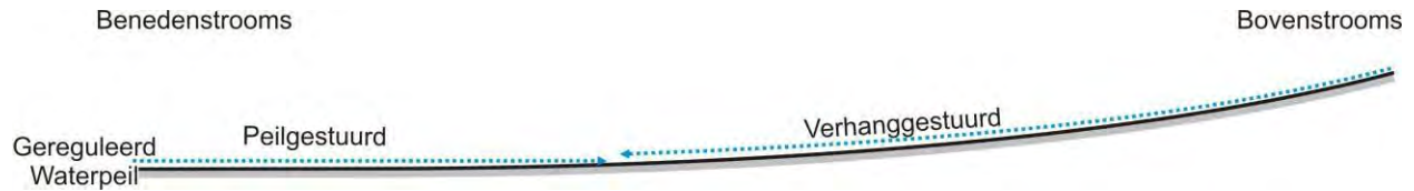
Figuur 2: Schematische weergave bodemdaling en peilaanpassing in het Drentsche Aa gebied.
