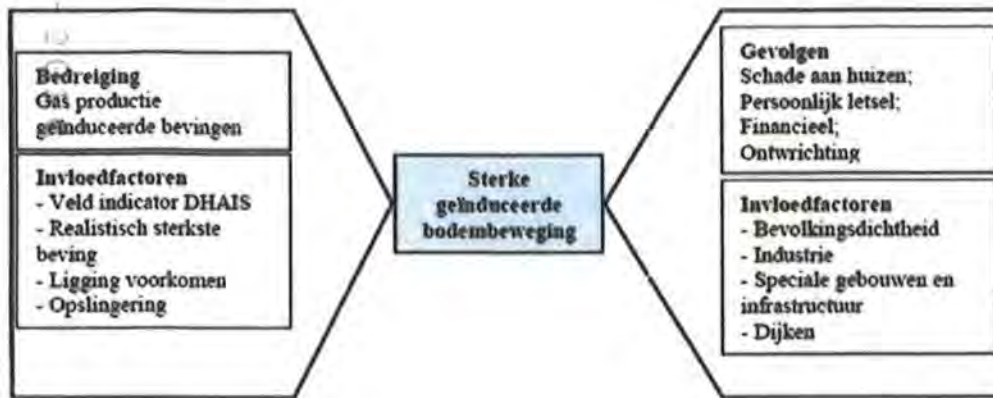
Figuur 3.2: Schematische weergave van de bedreigingen en gevolgen van geïnduceerde bevingen en de verschillende invloedfactoren die daarbij een rol spelen (SodM, 2016).
