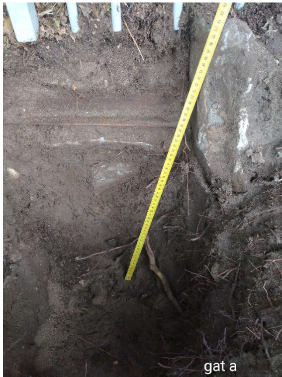
Afbeelding 18: Tot 60 cm-mv geen wortels aanwezig. Fundament zichtbaar van paal bestaat hekwerk;
