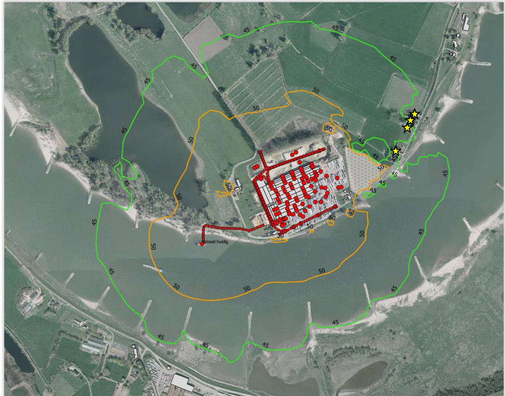
Geluidcontour dagperiode (1,5 m) steenfabriek incl. tasveld en de bestaande loswal (west) (Bron: akoestisch onderzoek LBP Sight) woningen Polder 13, 14, 15, 16 met gele sterren aange- duid
