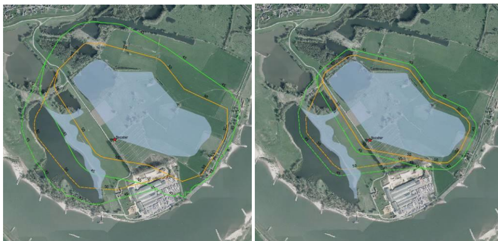
Figuur: geluidscontouren (45 en 50 dB(A) op 1,5 meter) van zuiger en booster (links=diesel, rechts=elektrisch) Bron: geluidsonderzoek
