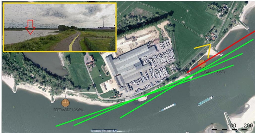
Figuur: zichtlijnen afvarend schip met laad- en losfaciliteit op locatie oost. De rode lijnen tonen de zichtlijnen waarin het zicht belemmerd wordt, de groene lijnen tonen de onbelemmerde zichtlijnen. De gele lijnen tonen het perspectief van de foto's in de gele kaders.
