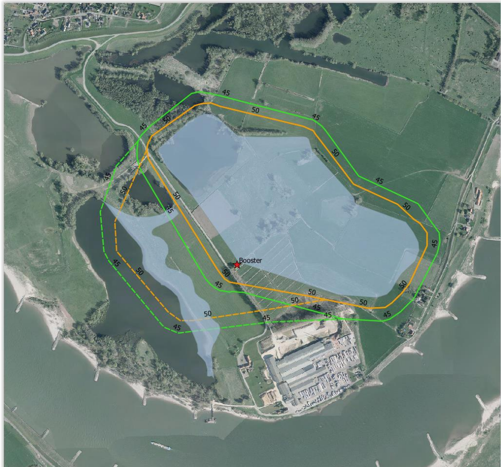
Geluidcontouren 45 en 50 dB(A) op 1,5 meter bij gebruik van een elektrische aangedreven zuiger en booster (Bron: akoestisch onderzoek LBP Sight)
